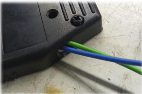
Führen Sie danach das grüne Kabel (Taster) und bei Bedarf auch zeitgleich das blaue Kabel (für die automatische Start/Stoppfunktion) durch die seitliche Bohrung des Gehäuses hindurch.
