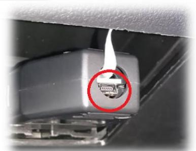
Nach der Installation verbinden Sie das Hauptmodul mit der USB-Schnittstelle des Computers. An der Öffnung des Gehäuses finden Sie die USB-Micro-Schnittstelle (Micro-USB Kabel nicht im Lieferumfang).
