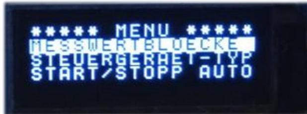
Durch einen kurzen Druck auf den Touchtaster, wird die Liste durchgeblättert. Ein langer Druck auf den Touchtaster, aktiviert die markierte Menufunktion. In den Untermenüs ist die Menüführung identisch. Ein langer Druck bedeutet immer abspeichern des Wertes, ein kurzer Druck blättert die Werte durch.
