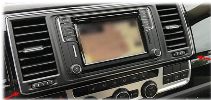
Um an den SSA-Taster heran zu kommen, muss der komplette Rahmen inkl. Der Lüftungsschächte um das Radio entfernt werden. Dieser Rahmen ist mit 8 Klemmspannen befestigt (siehe rote Pfeile). Den Rahmen hebt man am besten an den beiden unteren Ecken nach vorn. Auf der linken Seite mit einem Plastik-Tool oder
