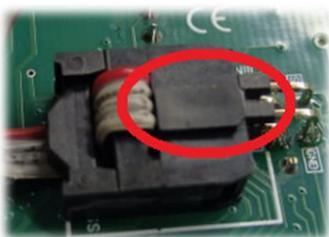
Achten Sie beim Zusammensetzen darauf, dass die Kunststoff-Nase am Flachbandkabel nach oben gerichtet sein muss!
